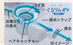
※効果的なうず流を発生させるためには、浴槽水位が150mm以上必要です。
